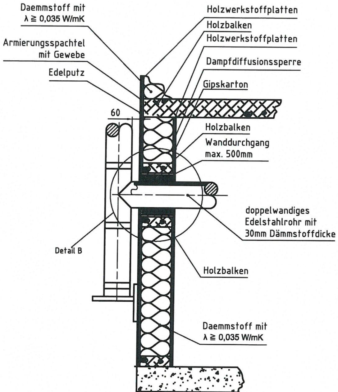
Bauelemente zur Herstellung von Wand-, Decken- und Dachdurchführungen
