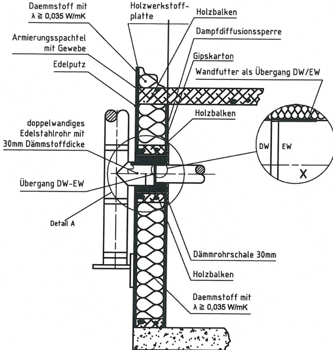
Bauelemente zur Herstellung von Wand-, Decken- und Dachdurchführungen
