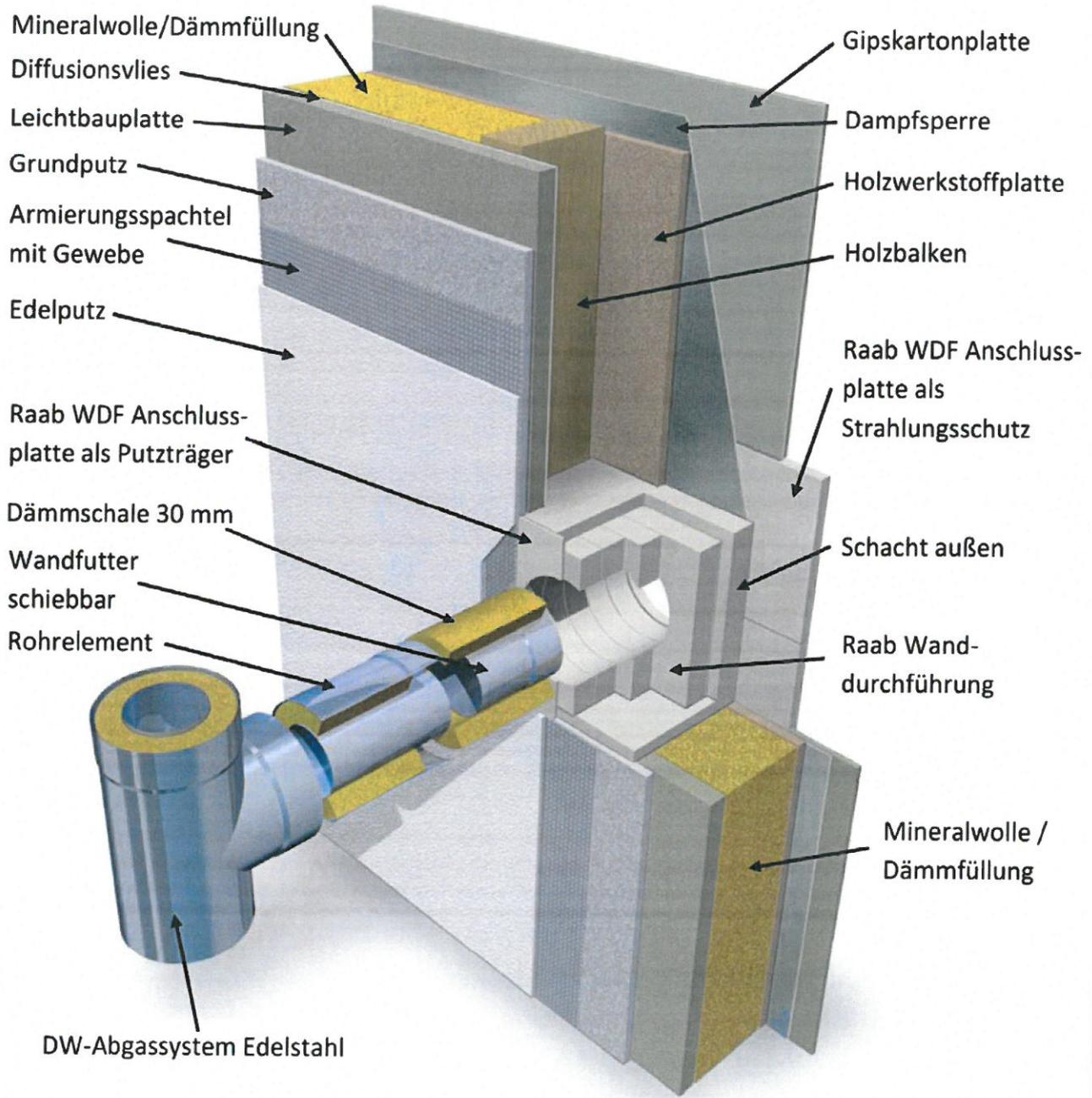
Bauelemente zur Herstellung von Wand-, Decken- und Dachdurchführungen
