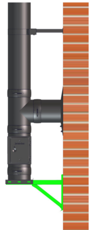
Bild 3-4: Aufbau Grundplatte mit Kondensatablauf und Wandstütze „schenkelabwärts“
